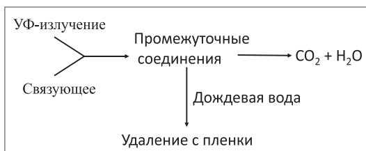
Рис. 1. Деструкция лакокрасочных пленок в результате поглощения УФ-излучения
